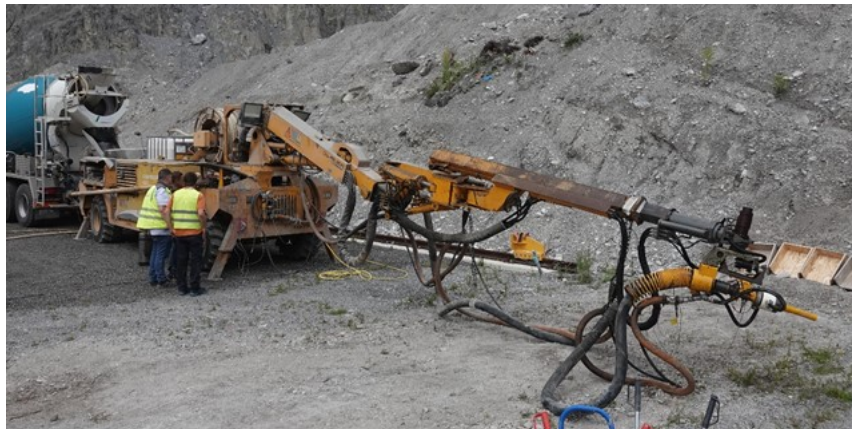
Abbildung 2.4.5: Impression des Spritzversuchs Zams IV, im Bild das eingesetzte Spritzgeräte PM 500 zur Verfügung gestellt von Sika Services.
